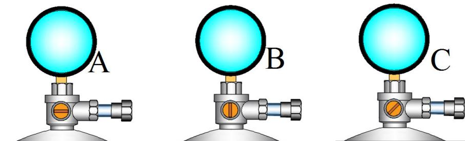
5.8. Порядок подачки воздуха в воздушную камеру гасителя:
