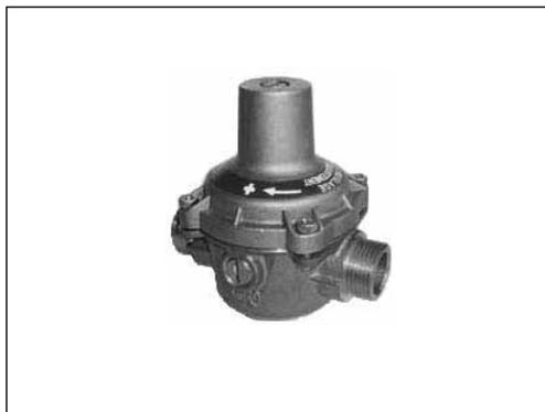
Клапаны редукционные типа 11BIS являются регуляторами давления прямого действия «после себя» и предназначены для снижения и поддержания постоянного давления за клапаном вне зависимости от колебаний давления до него.
