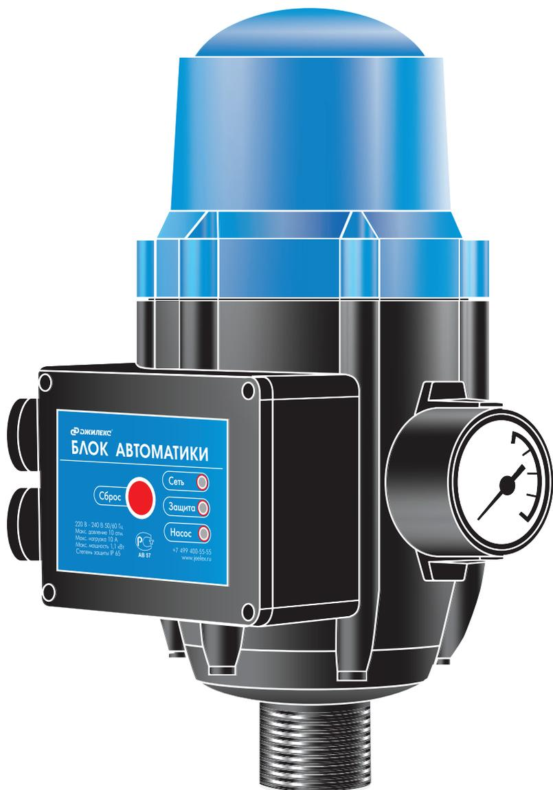
**1.1** Блок автоматики позволяет автоматизировать работу электронасоса, запуск при понижении давления (открытие кранов), или остановку при прекращении водного потока в системе водоснабжения (закрытие кранов). Кроме того, блок автоматики защищает электронасос от работы без воды («сухого хода»).
