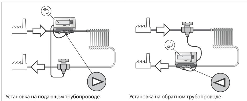
Установка на подающем трубопроводе
