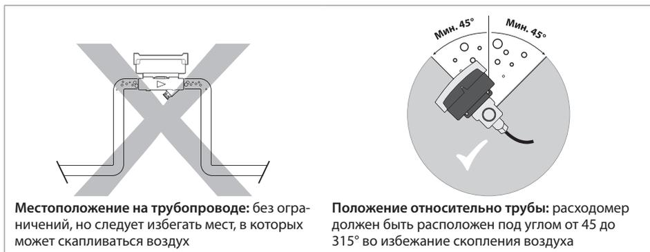
Местоположение на трубопроводе: без ограничений, но следует избегать мест, в которых может скапливаться воздух
