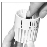
4 Photo 4: Pour limiter la valeur de consigne inférieure, par ex. sur chiffre «2» (environ 16°C), faire glisser un clip dans la nervure devant le chiffre «2» comme sur le photo. (La nervure en face du chiffre «2» reste libre.)
